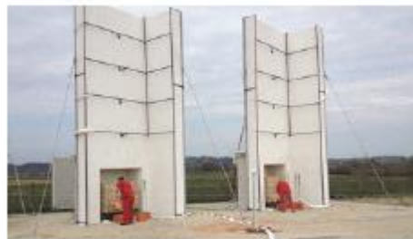
Paljenje konstrukcije od drvenih letvica – početak požara
