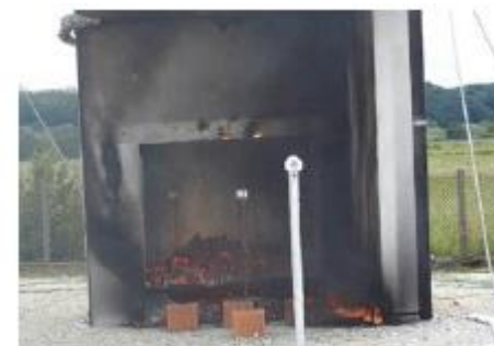
54 minute nakon početka – tinjanje uzorka EM_2
